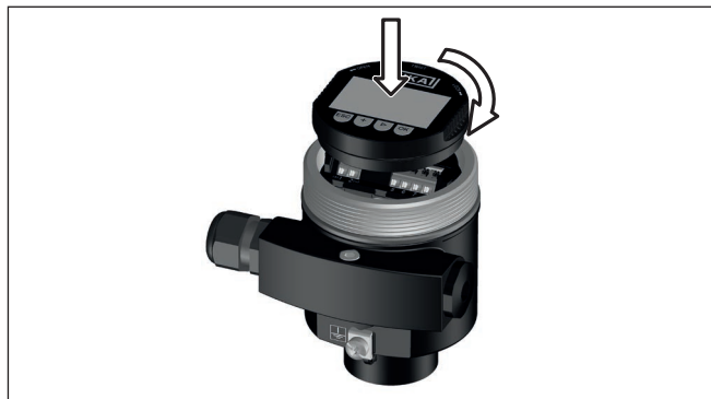
Рис. 1: Установка модуля индикации и настройки в отсеке электроники однокамерного корпуса
