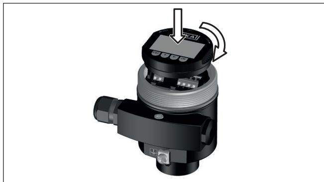
Rys. 38: Wkładanie modułu wyświetlającego i obsługowego do komory układu elektronicznego w obudowie jednokomorowej
