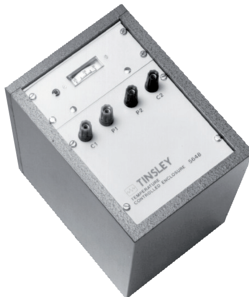
Obudowa termiczna dla rezystorów CER6000-RW, ze stałą temperaturą 36 °C [97 °F]
